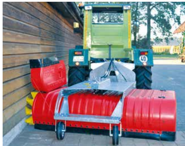
Wandbündiges Fegen für Sauberkeit bis an die Kanten durch einfaches Hochklappen der Seitenteile.
