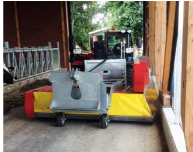
Selbst die Montage von zwei Anbauplatten ist möglich. So kann eine Maschine für Front und Heck genutzt werden.
