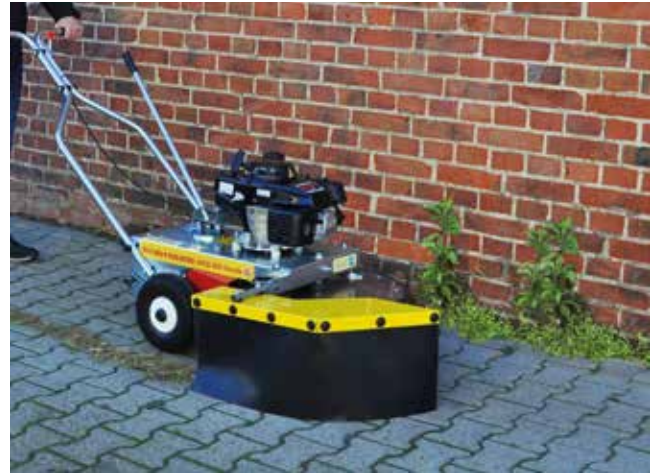
Schwadformer / Spritzschutz kann werkzeuglos angebracht werden.
