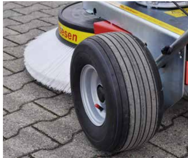
Breite Ballonreifen vergrößern die Auflagefläche für schonendes Arbeiten auf Tennisplätzen und Pflanzfolien.
