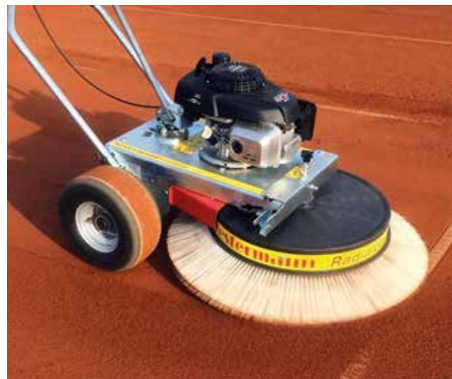
Problemloses Überfahren der Tennislinien, welches das händische Entfernen des Ziegelmehl unnötig macht.
