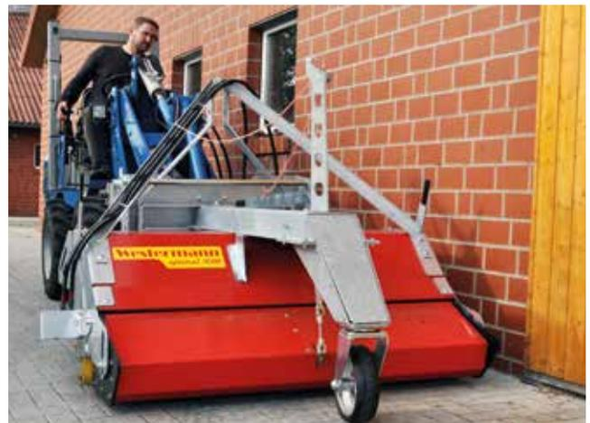
Die hohe Wendigkeit der Kehrmaschine ermöglicht ein sicheres Rangieren auch in Wandnähe.
