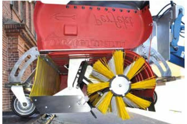
Die pendelnd aufgehängte Bürstenwalze und der integrierte Hydraulikzylinder passen sich dem Untergrund perfekt an und ermöglichen einen stetigen Bodendruck. Die Leerung der Sammelwanne ist simpel.
