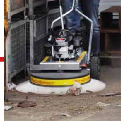
Mit handgeführten Radialbesen können Ecken und Kanten im Nu ausgefegt werden, sie sind allzeit bereit und ganzjährig nutzbar. Somit dienen sie als perfekte Ergänzung zur Kehmaschine ohne zusätzlichen Seitenbesen.
