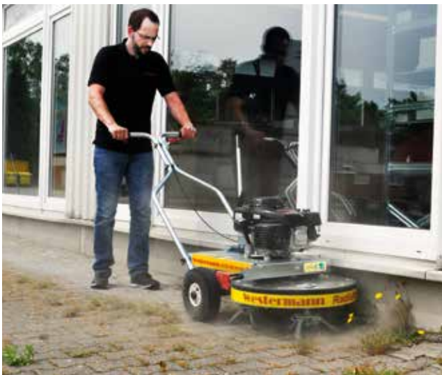
Sämtliche Fugen werden gründlich gereinigt, große Teile des Wurzelsystems werden mit entfernt.
