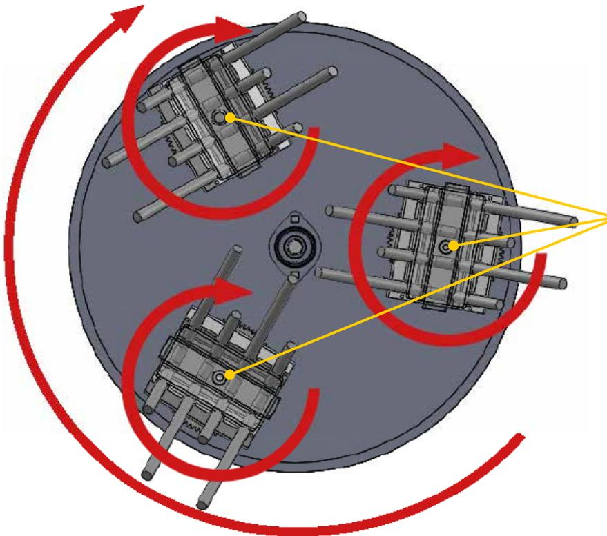
Drei rotierende Bürstenträger und der dadurch entstehende gleichmäßige Bodendruck verhindern das Verkratzen des Untergrunds.
