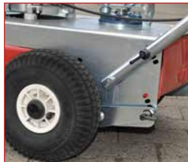
Höhenverstellbare Radaufhängung passt sich der Borstenlänge an, sodass eine permanente, gleichmäßige Bürstenauflage gewährleistet wird.
